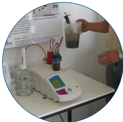
Fig. 1: El valorador TIM 840 para la determinación de FOS/TAC en la planta de biogás de Wambeln.
