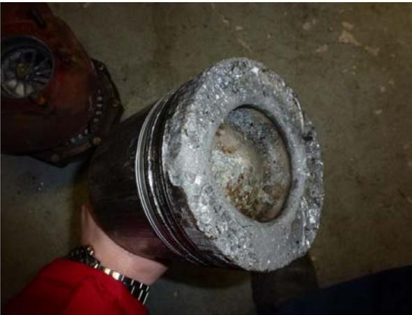
thermisch überlasteter Kolben
